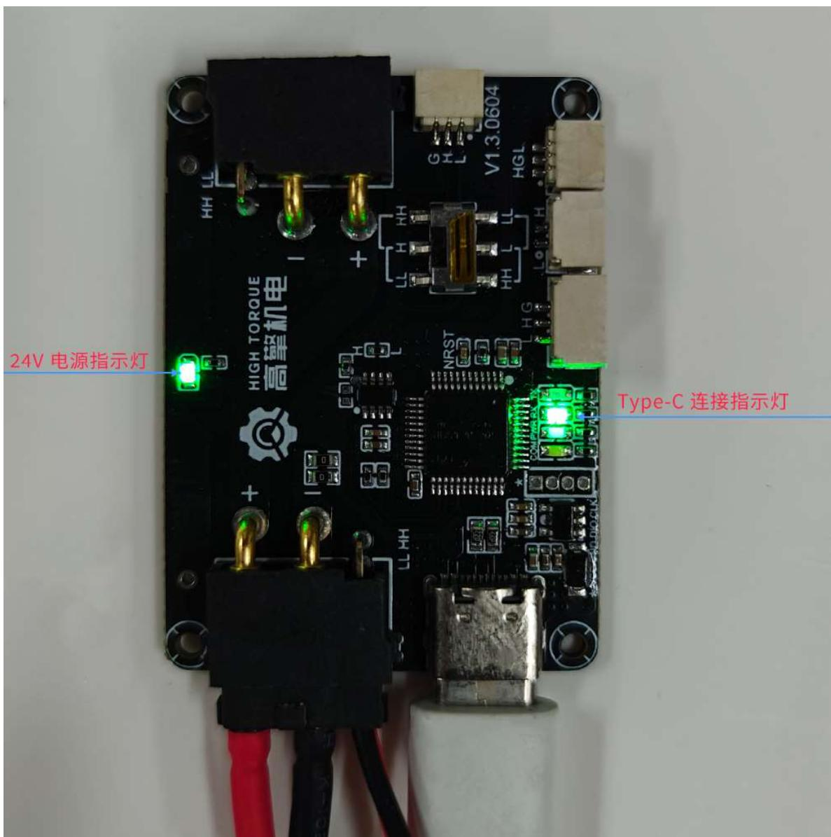
注: 请保证电机can线线序与FDCAN模块线序正确无误, 当打开上位机通讯时, can模块灯会闪烁。
