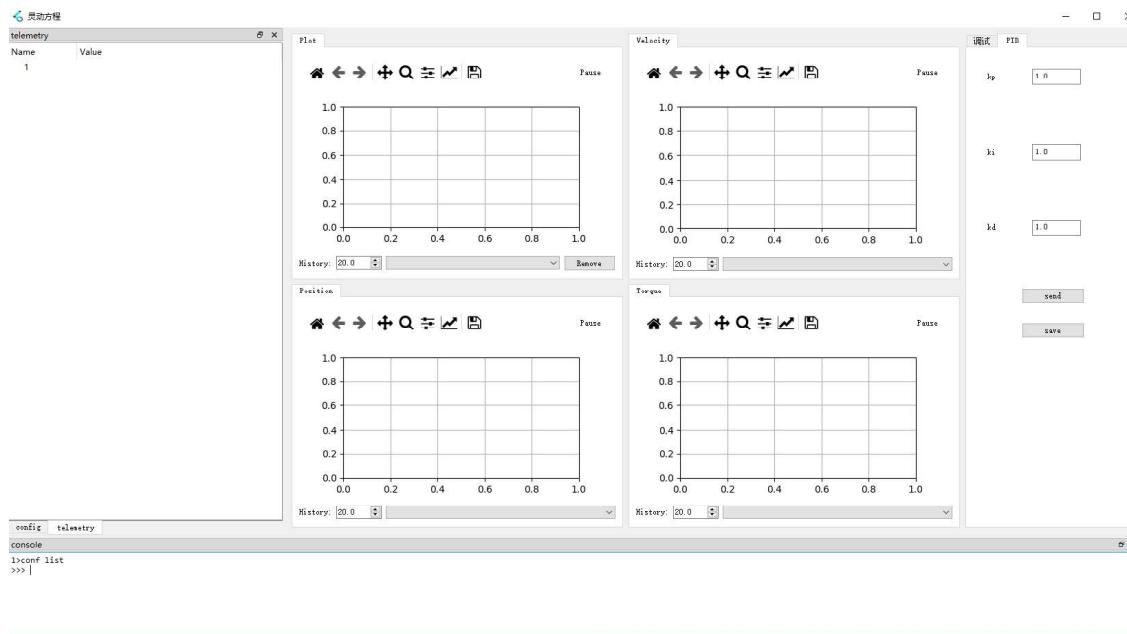
3. 接下来我们把上位机的两个窗口都关闭，重新打开上位机，上位机会自动识别到更改后的ID。点击“**打开Tview**”，在上位机命令行中输入保存指令**conf write**保存ID，反馈**OK**后即为ID修改成功，如下图所示。
