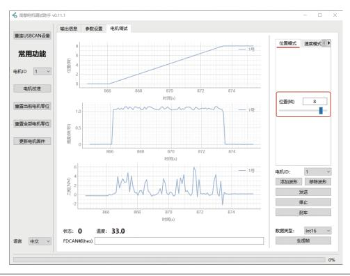
2 速度模式 设定速度点击发送,电机以最大加速度转到指定速度,如在参数设置里 设定了加速度限制,则以设定的加速度转到指定速度转动;
