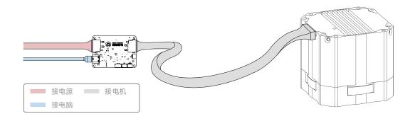
② 电机XT30接口与FDCAN模块相连,FDCAN模块typc接口连接电脑,用GH1.25\_3P线连接电机和FDCAN模块,电机电源接FDCAN模块。
