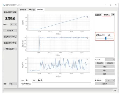
6 力矩模式 设定力矩点击发送,电机按指定的力矩进行输出,如外部阻力大于设定 的力矩, 电机会堵转;
