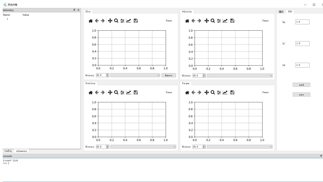
3. 接下来我们把上位机的两个窗口都关闭，重新打开上位机，上位机会自动识别到更改后的ID。点击“**打开Tview**”，在上位机命令行中输入保存指令**conf write**保存ID，反馈**OK**后即为ID修改成功，如下图所示。
