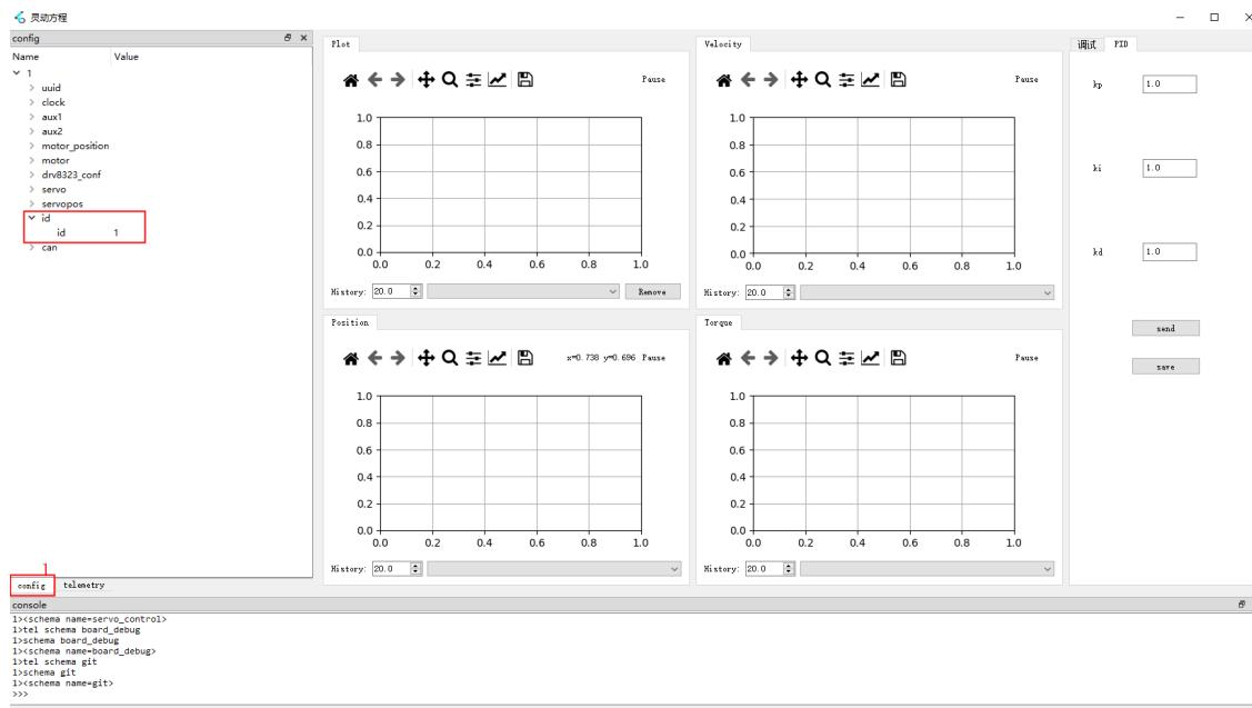
2. 修改后直接关闭当前窗口，再重新打开，可以发现上位机中没有驱动板信息如下图所示，因为已经修改了驱动板id为2。
